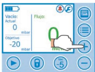
8. Ajuste el vacío nominal con +/- y Vac -5.
