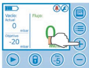
10. Ajuste el vacío nominal con +/- y Vac -5.
