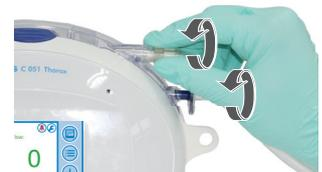
5. Retirer le système de tubulure du bocal à sécrétions
