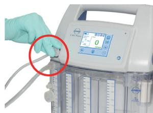
» Connexion du canal à sécrétions au bocal à sécrétions
