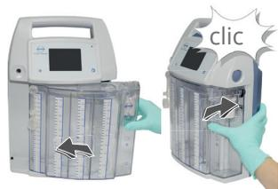
1. Si nécessaire, remplir le verrouillage hydraulique
