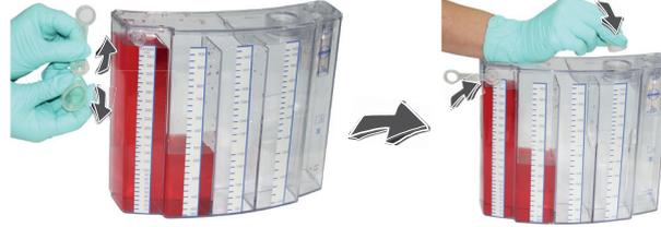
8. Fermer la soupape Pop-Off et le canal à sécrétions avec les bouchons correspondants.
