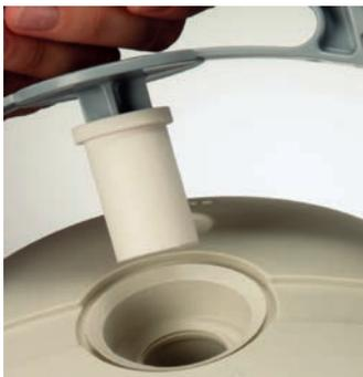
1. Um den DDS-Sekretbehältergriff **aufzusetzen**, führen Sie ihn in die Nuten des Behälterdeckels (bei geöffneten Rasthaken) ein.
