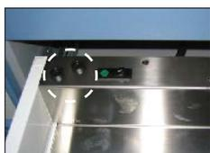
Ouvrir le support à fusibles situé à côté de l'interrupteur principal et remplacer le fusible.
