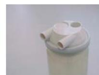
Mettre en place le joint (3) mettre le couvercle sur le vase (6)
