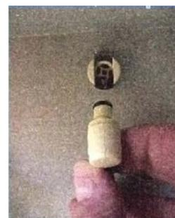
Raccorder le tuyau d'air dans l'espace de maintenance.
