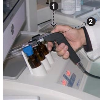
Inserte el pulverizador en el soporte
