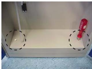
Ajuste los tornillos de la base con un destornillador plano del 4 al 5.
