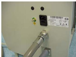
**i** Conecte el cable en la clavija.
