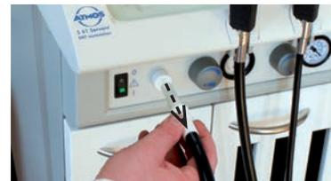
**i** Después de cada aplicación, enjuague el tubo de aspiración. Conecte el tubo (sin cánula) con la boquilla, al elemento de aspiración para el lavado de tubos, y absorber durante unos 30 segundos.
