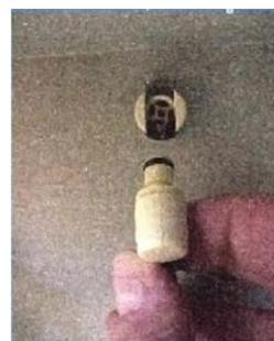
Conecte el tubo de aire comprimido en el compartimiento de servicio
