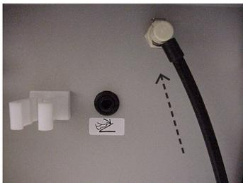
Drucklufthandgriff mit dem Drucksystem verbinden.
