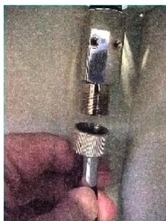
Wasserschlauch im Serviceraum anschließen.
