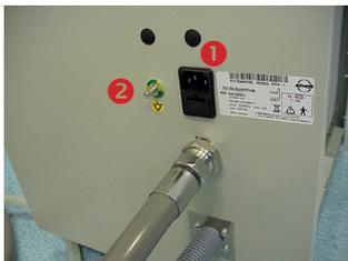
Verbinden Sie das Netzkabel mit dem Kaltgerätestecker ① und die Potenzialausgleichskabel mit dem Potenzialausgleichsstecker ②.
