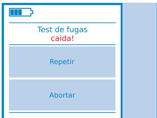
Si la prueba de estanqueidad detecta fallos, aparece el mensaje “Test de fugas caída”. Revise las conexiones de tubo y compruebe si el depósito está bien encajado. Pulsando el botón correspondiente, ahora tiene la posibilidad de
