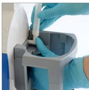
2. Positionner le bocal extérieur Serres® debout et le faire glisser de haut en bas dans le support. La graduation doit être visible.
