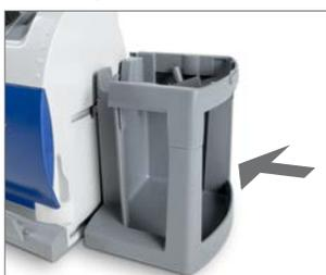
2. Deslice el soporte para sistemas de contenedores DDS hacia delante hasta que quede enrasado con el dispositivo. La entrada de la bomba debe ser visible.
