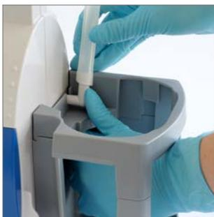
2. Coloque el contenedor exterior Serres® en posición vertical en el soporte desde arriba. La escala debe ser visible.
