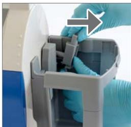
2. Deslice el soporte para el sistema de contenedores DDS hacia atrás hasta el centro y retírelo de las guías.
