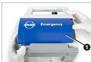
6. Levante la tapa del compartimento de la batería por la parte inferior y extráigala de la guía superior.
