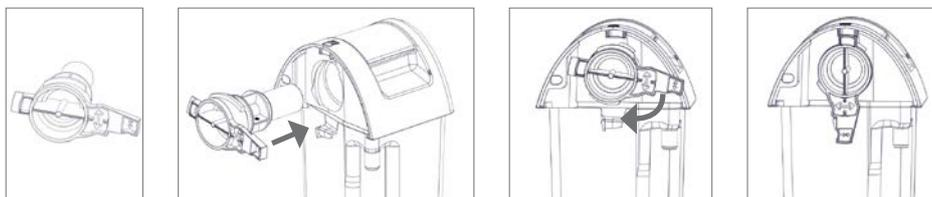
11. Connecter la tubulure d'aspiration au système de recueil.
