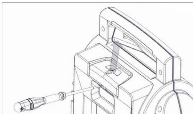
2. Mettre en place la nouvelle touche de déverrouillage. Veiller à ce que les deux ressorts rentrent bien dans les rails de la touche de déverrouillage.
