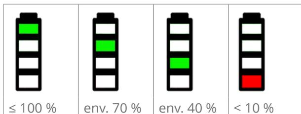
L'état de charge de la batterie doit être surveillé visuellement.
