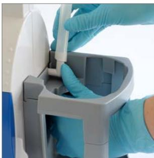
2. Positionner le bocal extérieur Serres® debout et le faire glisser de haut en bas dans le support. La graduation doit être visible.
