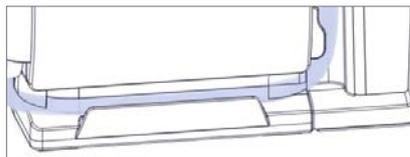
16. Enrouler la tubulure d'aspiration sur le support de tubulure.
