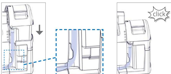
13. Vérifier que la languette du couvercle **1** est bien en place sur le support du système de recueil.
