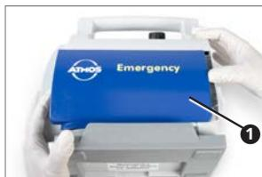
6. Soulever le capot de l'espace batterie par en-bas et le retirer du rail supérieur.
