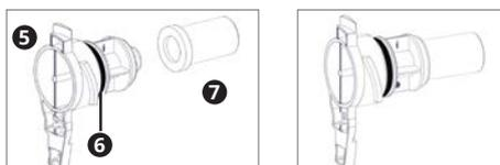
10. Pousser le support de filtre dans le couvercle et tourner le support de filtre dans le sens des aiguilles d'une montre, jusqu'au clic.
