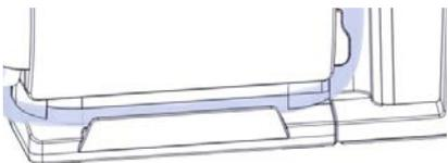
10. Enrouler la tubulure d'aspiration sur le support de tubulure.
