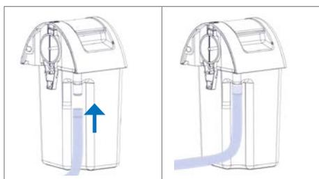
11. Mettre en place le système de recueil de manière verticale de haut en bas dans le support : chapitre „3.4 Mettre en place et retirer le système de recueil et les tubulures“ à la page 22.
