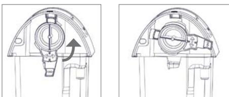
7. Retirer le support de filtre avec filtre DDS antibactérien et antiviral du couvercle.
