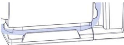
11. Enrouler la tubulure d'aspiration sur le support de tubulure.
