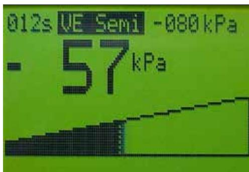
Fig. 26 Liberación de vacío en VE Semi Modo
