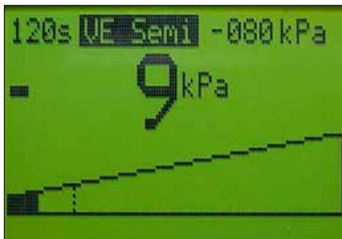
Fig. 20 VE Semi Modo. El equipo trata de generar un vacío base de -20 kPa
