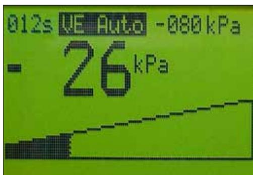
Fig. 25 Liberación de vacío en VE Auto Modo
