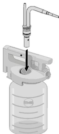
Fig. 5. Colocación de la boquilla doble
