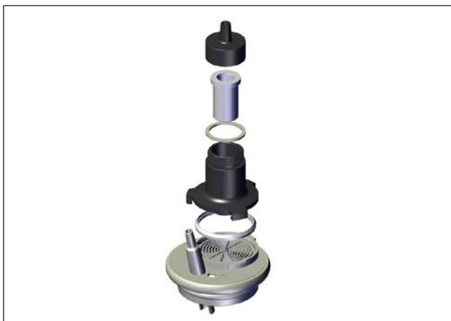
Fig. 33. Couvercle avec filtre antibactérien intégré.
