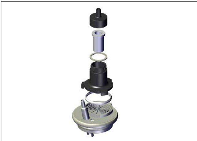
Fig. 33. Tapa con filtro bacteriano integrado
