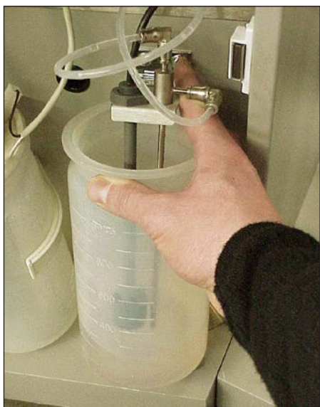
Fig. 35. Cambio del contenedor de lavado
