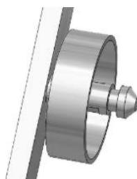
5. Geräteschiene mit Bolzen in das Wandstück bis zum Grund stecken.
